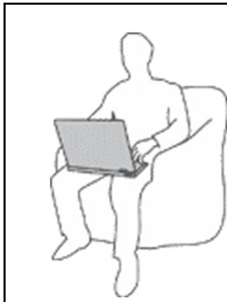
Когда компьютер включен или заряжается аккумулятор, основание компьютера, подставка для рук и некоторые другие части компьютера могут нагреваться. Температура этих частей зависит от интенсивности работы компьютера и уровня зарядки аккумулятора.
