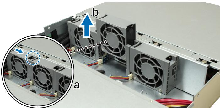
**a** Найдите неисправный вентилятор. Нажмите и удерживайте кнопку, расположенную в левой части вентилятора.
